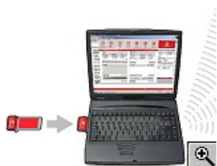
Bild 7.1: Notebook mit Einschubkarte für die UMTS-Nutzung Hardware-Komponenten für DSL
