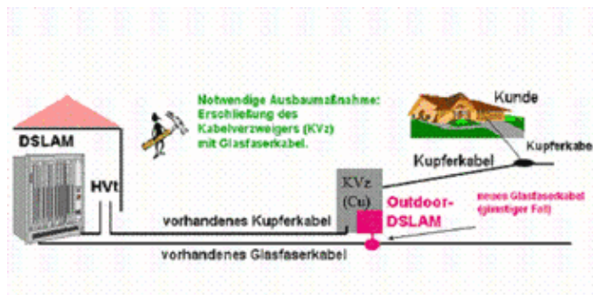
Bild 2.2: Konfiguration einer DSLAM-Versorgung; Quelle: T-COM
